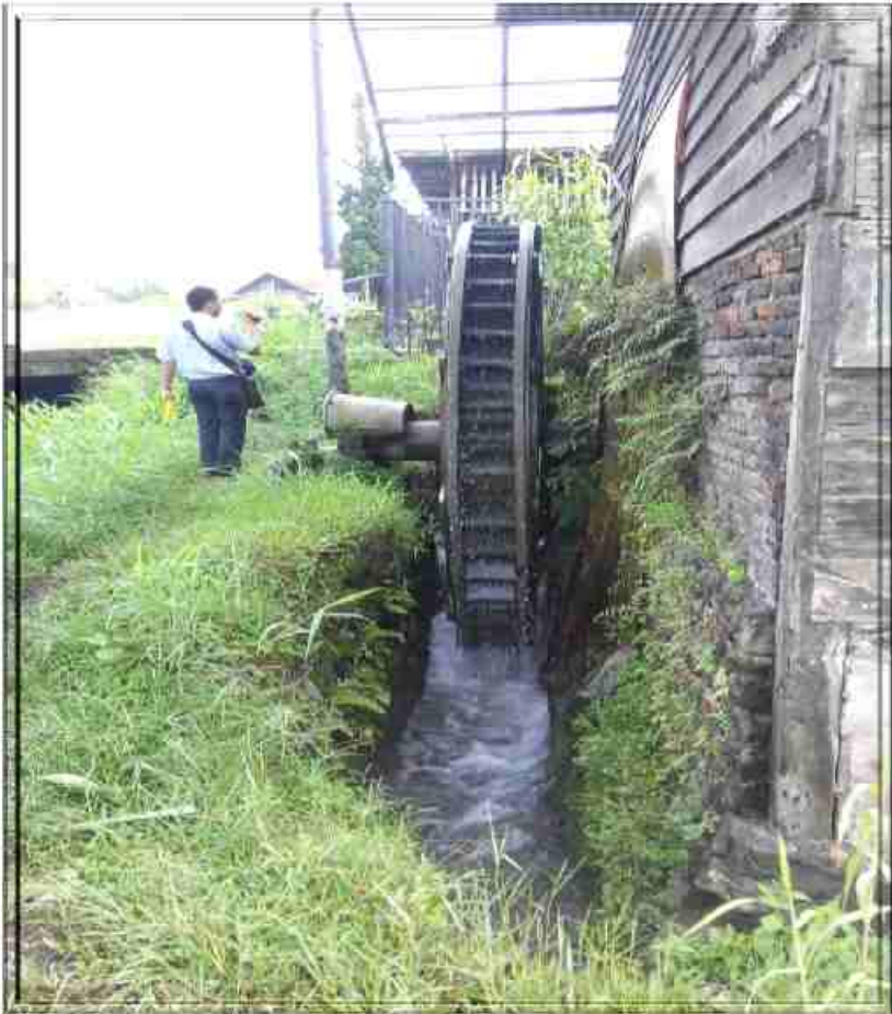
Gambar 18. Kincir air penggerak generator untuk penumbuk tepung beras di Padang Panjang.
